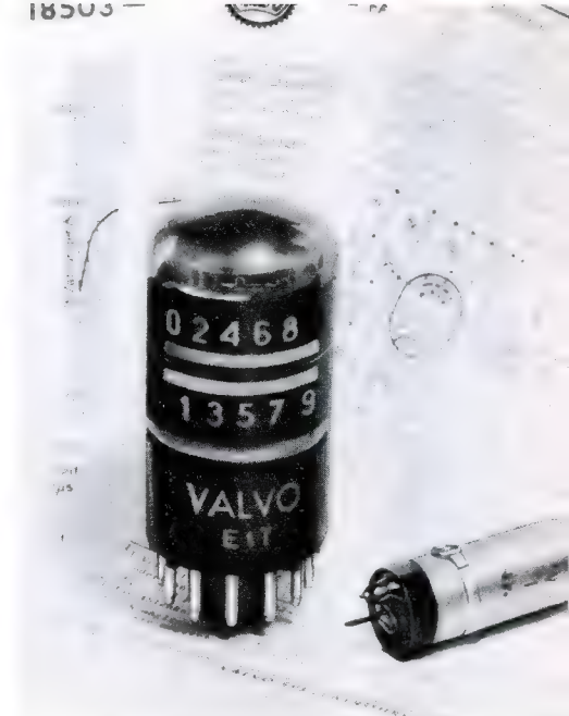
Bild 1. Dezimal-Zählröhre Valvo E 1 T (stehend) und Geiger-Müller-Zählrohr Valvo 18503 (liegend)
