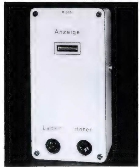
Bild 1. Geiger-Müller-Zähler M 576. Hinter dem kleinen Fenster im oberen Teil befindet sich die Abstimmröhre DM 70. Durch ihr Aufblitzen wird radioaktive Strahlung angezeigt; sie kann außerdem durch einen eingestöpselten Kopfhörer als Knacken hörbar gemacht werden. Der kleine Knopf an der rechten Seitenwand dient zum Einschalten des Gerätes
