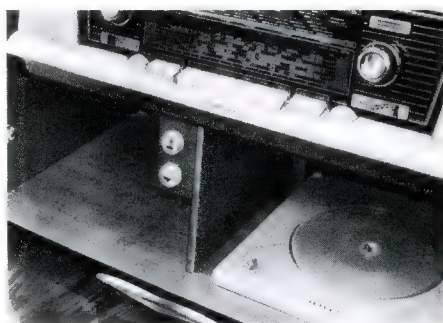
Bild 2. Einbau des Stereo-Zusatzverstärkers bei den „stereo-sicheren“ Schaub-Lorenz-Musiktuben
